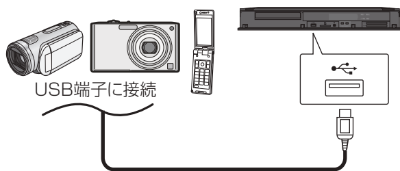
USB接続ケーブル (USB機器の付属品など指定のケーブル)
