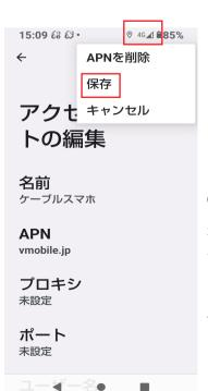
⑨赤枠の「保存」を選択。画面右上のアンテナマークに 4G・5G が表示されれば設定完了です。
